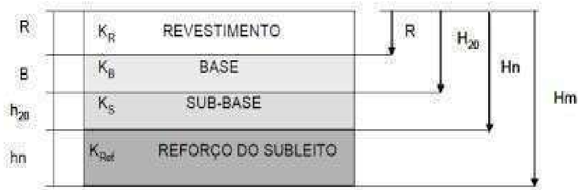
Figura 03. Dimensionamento de pavimento flexível
